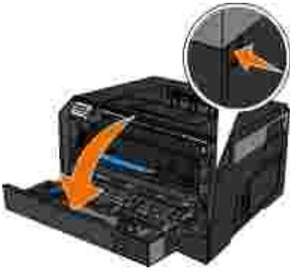
3. Presione el botón de la base del tambor de imágenes y suba y extraiga el conjunto del cartucho mediante la palanca.
