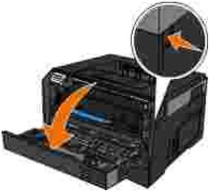
2. Extraiga el conjunto del cartucho de t ner de la impresora, tirando de la palanca del cartucho de t ner.
