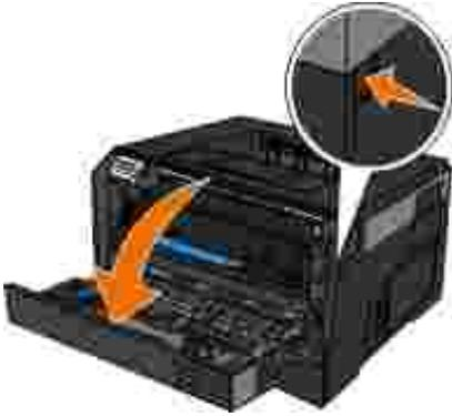
3. Extraiga el conjunto del cartucho de tóner de la impresora, tirando de la palanca del cartucho de tóner.
